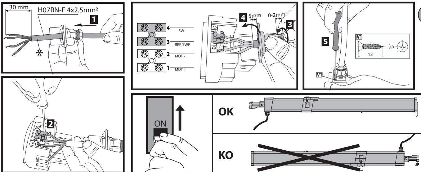
Ligar antes da instalação - Συνδέστε πριν από την εγκατάσταση - Wykonać okablowanie przed zainstalowaniem - Проложить кабель перед установкой - Kabely zapojte před instalací - Kurmadan önce kabloları bağlayınız
